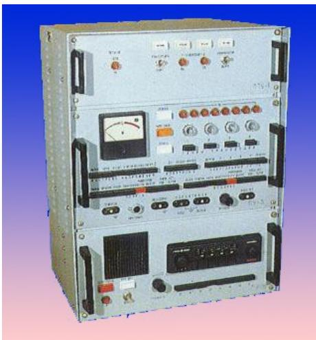
Аппаратура предназначена для обеспечения громкоговорящей связи и трансляции служебных и вещательных передач на объектах с высоким уровнем запыленности и влажности, в условиях сильных шумов. В состав аппаратуры входят 90 номенклатурных приборов, позволяющих создавать следующие схемы связи:
