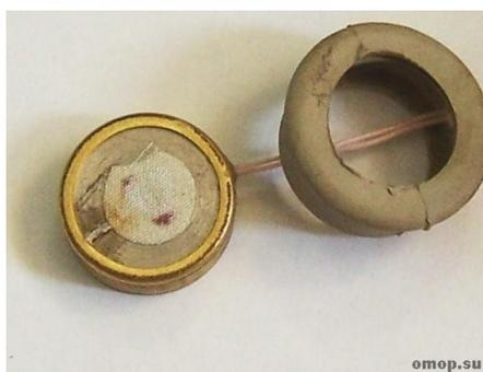
Электромагнитный микрофон работает следующим образом: Перед полюсами (полюсными наконечниками) 2 магнита 3 располагают ферромагнитную диафрагму 1 или скрепленный с ней якорь. При колебаниях диафрагмы под воздействием на нее звукового давления меняется магнитное сопротивление системы, а значит, и магнитный поток через витки обмотки, намотанной на магнитопровод этой системы. Благодаря этому на зажимах обмотки возникает переменное напряжение звуковой частоты, являющееся выходным сигналом микрофона.
